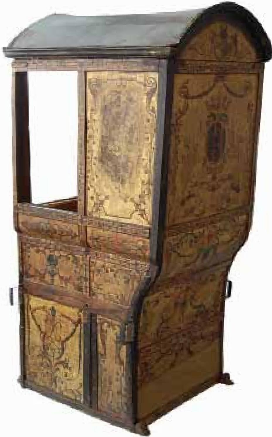
Cet habitacle est constitué d'un bâti en bois fait de montants et traverses rectilignes générant des élévations planes. Malgré le décrochement de la face arrière et les légers renflements des faces latérales, ménagés à hauteur du siège pour élargir l'espace intérieur et donner plus d'aisance au passager, la forme générale se caractérise par une grande raideur accusée par la composition géométrique des corps du bâti autour des panneaux.
